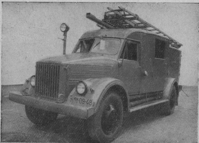
Рис. 1. Общий вид автонасоса АН-25 (51)-12.
